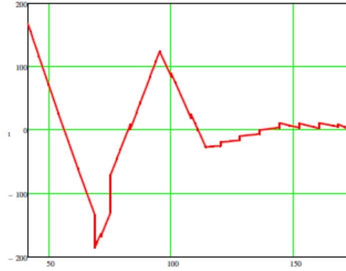
Moment fra stag og fjernet understøtning
